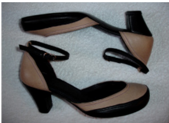
Fig. 8: Calçado construído pela autora de couro macio, com salto de madeira e solado antiderrapante; possui a diferença de altura de 3cm, sendo 1cm na planta e 2cm de salto. Fonte: a autora.
